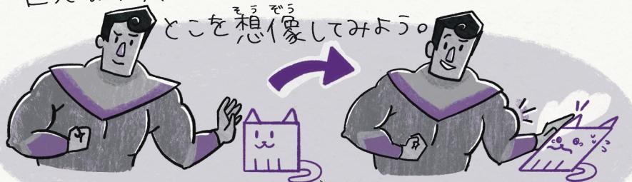
このねこをなでる力が、応力。このねこが横にかたちを変えたら、それがひずみ。大きな応力は、大きなひずみにつながるよ。
